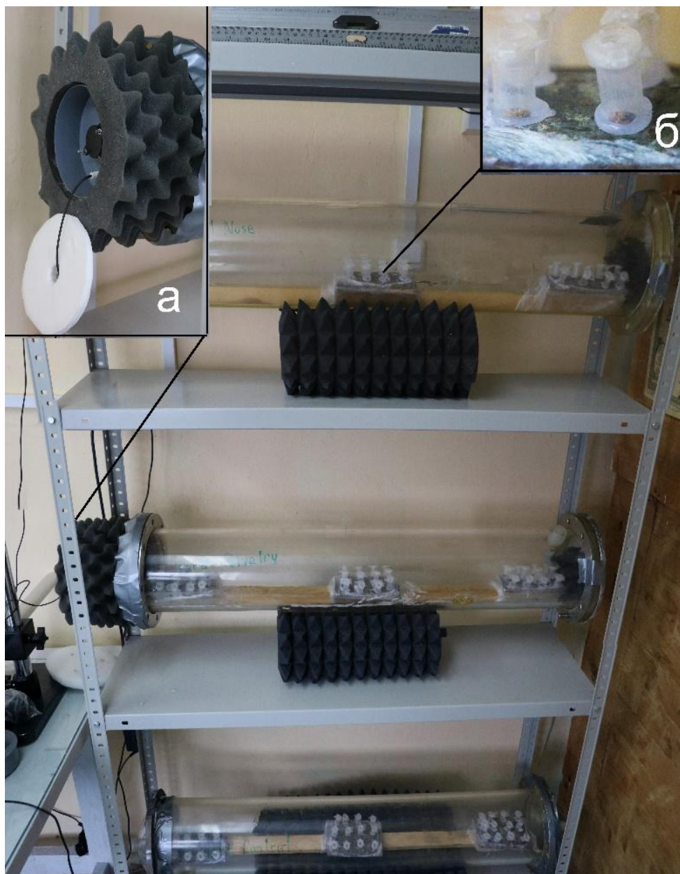
Рисунок 2.6. Установка трансляции конспецифического сигнала соперничества, заселяющимся семьям уссурийского полиграфа (а – транслятор акустического сигнала; б – экспозиция короедов на пихтовых выколотках в трубках, закрытых мельничным газом)
