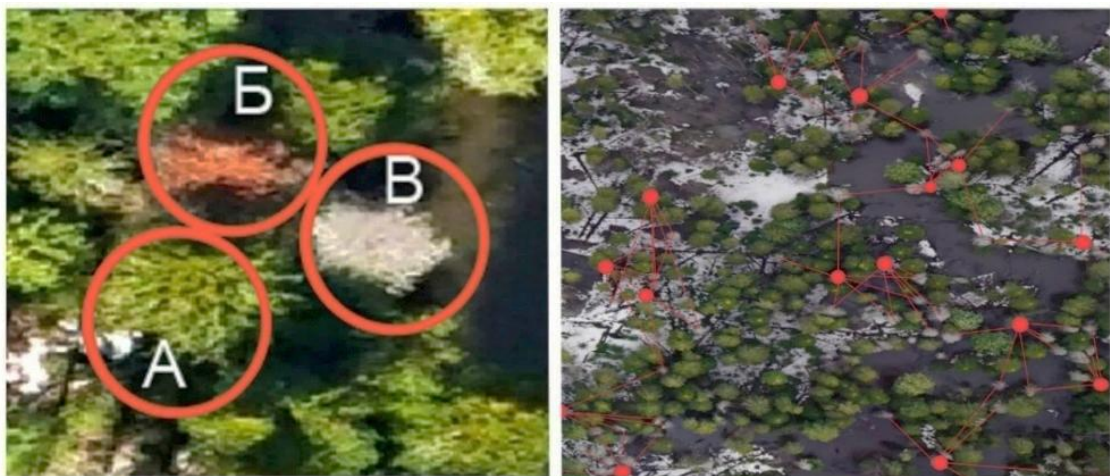
Рисунок 4.1. Методика определения категорий состояния деревьев пихты на ортофотоснимках (Справа: V и VI категории; А – I-III категория состояния; Б – V категория, В – VI категория. Слева: методика измерения расстояний между деревьями V и VI категорий)
